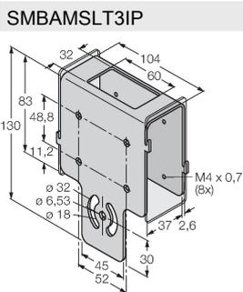
Schutzgehäuse mit Schutzglas, Edelstahl, für Bauform LT3
