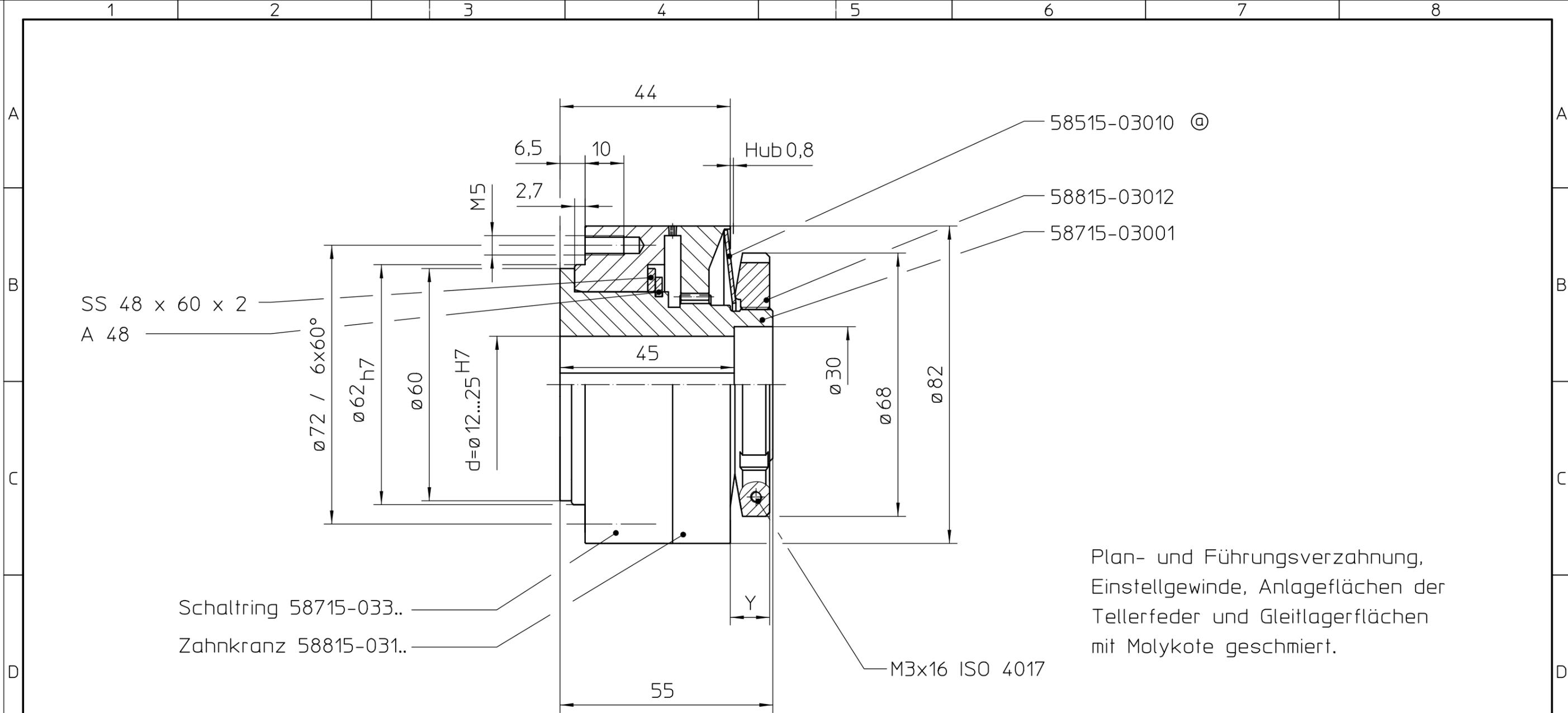
Plan- und Führungsverzahnung, Einstellgewinde, Anlageflächen der Tellerfeder und Gleitlagerflächen mit Molykote geschmiert.
